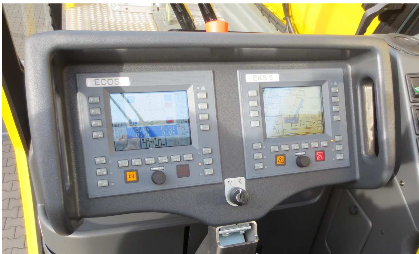
Shodný panel s modernějším bezpečnostním zařízením EKS5 Graphic
