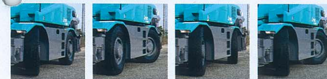
ノーマルステアリング リアステアリング クラブステアリング クランプステアリング
