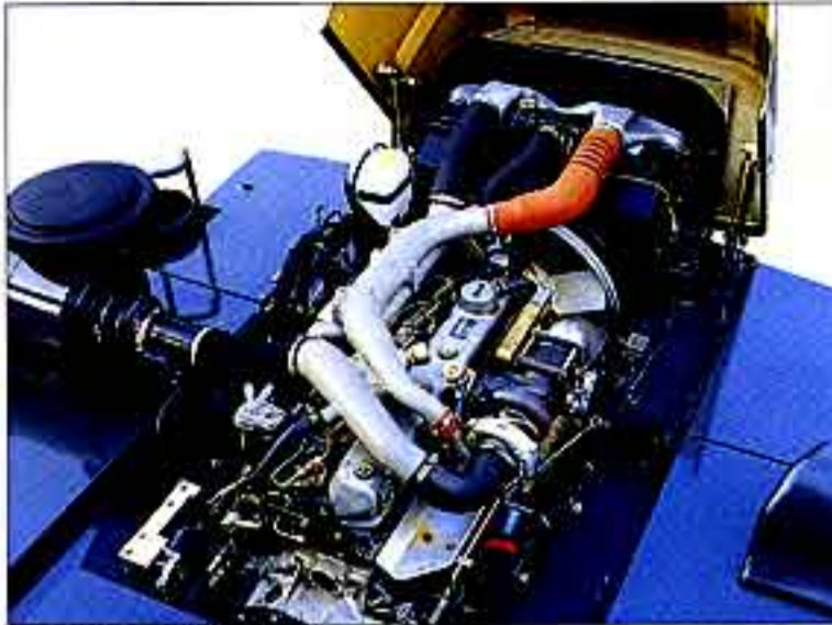
●低燃費・低騒音を両立。 「排出ガス対策型」の強力な250PSインタークーラー付ターボエンジン
