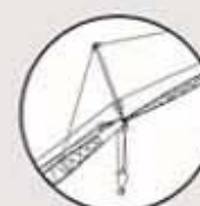
固定副臂工况 Fixed jib
