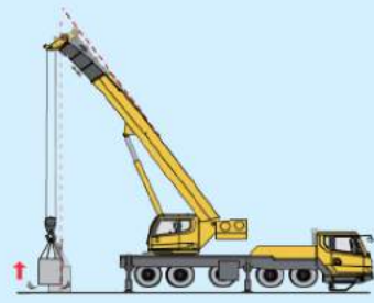
重物离地瞬间吊臂变形
