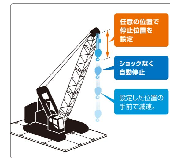
注)本装置は従来の過巻リミットスイッチの補助的役割を果たすものであり、クレーン作業を行うフックには過巻リミットスイッチが必要となります。
