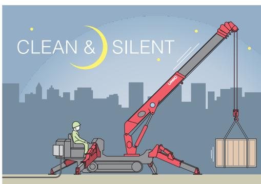
排出ガスゼロ。エンジン騒音がなく夜間の市街地や屋内での作業・移動時などでクリーン＆サイレントなクレーン作業を実現します。エンジンと電動モータの切り替えもカンタンです。
