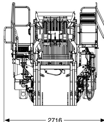
\* with 2<sup>nd</sup> and 3<sup>rd</sup> winch, setup winch and pulley carrier · mit 2. und 3. Winde, Rüstwinde und Rollenträger · avec 2ème et 3ème treuil, treuil de montage et porte-poulie
